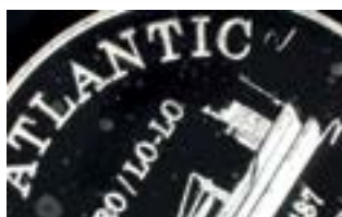
Moneta srebrna bez warstwy ochronnej z widocznymi białymi plamami.
